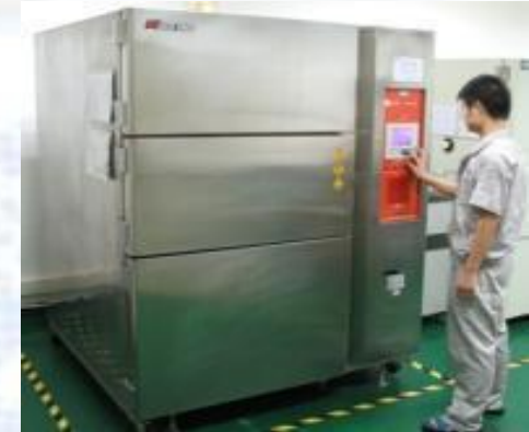
Thermal Shock Chamber High Temp : 60~150°C Low Temp : -30~-65°C
