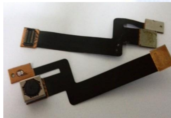
2 layers Camera module (FPCA)
